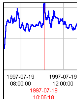
Det vertikala strecket placeras på önskad plats och både mätvärde och tidpunkt visas.
